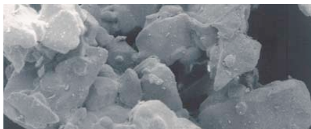
Kiirlahustuva ravimisuhkru 600-kordne suurendus. Pildil on näha osakeste poorsus.
