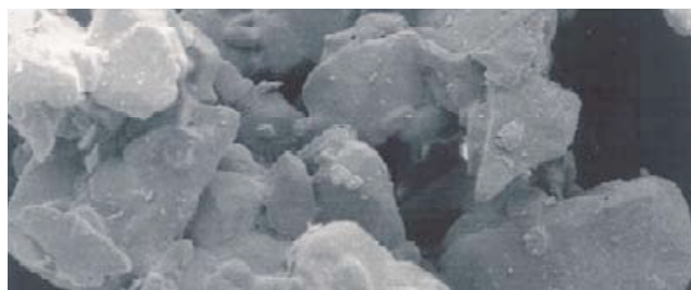
600-kertaisesti suurennettu Pharma Instant Sugar -hiukkanen. Kuvasta näkyy hiukkasen huokoinen rakenne.
